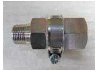
『本体L型・S型』、『オスコネクタ』、『クランプ』、『ホースバンド』、『オーリング』の5部品で構成されており構造はいたってシンプルでオーリング使用により油圧・空圧共に洩れの気密性も優れています。
